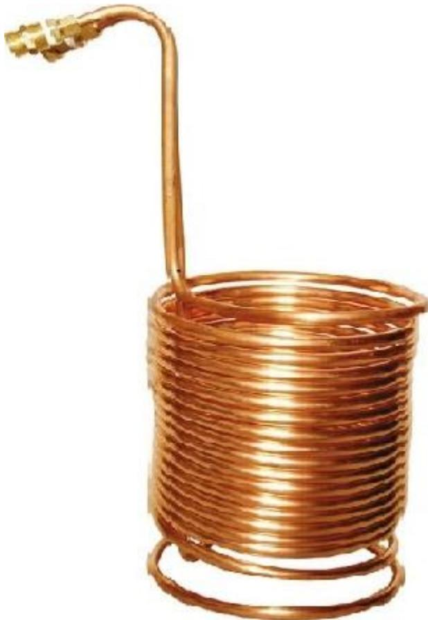
O chiller é um trocador de temperatura que é usado para resfriar o mosto ao final da fervura. No caso do chiller do tipo imersão, o equipamento é colocado dentro do mosto ainda quente e é passada água gelada por dentro dele para retirar o calor do mosto. Normalmente é feito em cobre, que é um material com boa condutividade térmica.
