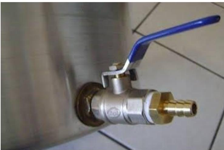
Na panela usada para fervura, instale uma válvula aço-inox ou ferro fundido e calcule o centro do furo aproximadamente três dedos do fundo. Isto ajudará você a retirar o mosto sem retirar junto o material que vai decantar no fundo da panela (lama do mosto). Lembre-se de sempre usar válvulas feitas em metal que não enferruje, como inox ou latão.
