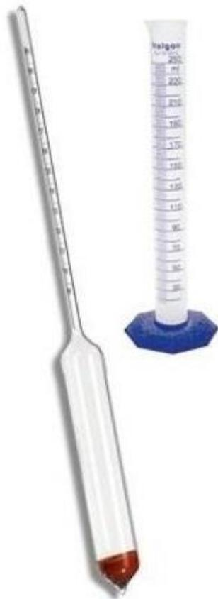
O densímetro e a proveta para o densímetro são equipamentos importantes. Eles servem para medir a densidade da cerveja ao final da fabricação. Estes equipamentos nos ajudarão a medir se conseguimos extrair bem os açúcares do malte e também nos ajudarão a estimar o percentual de álcool da cerveja pronta.
