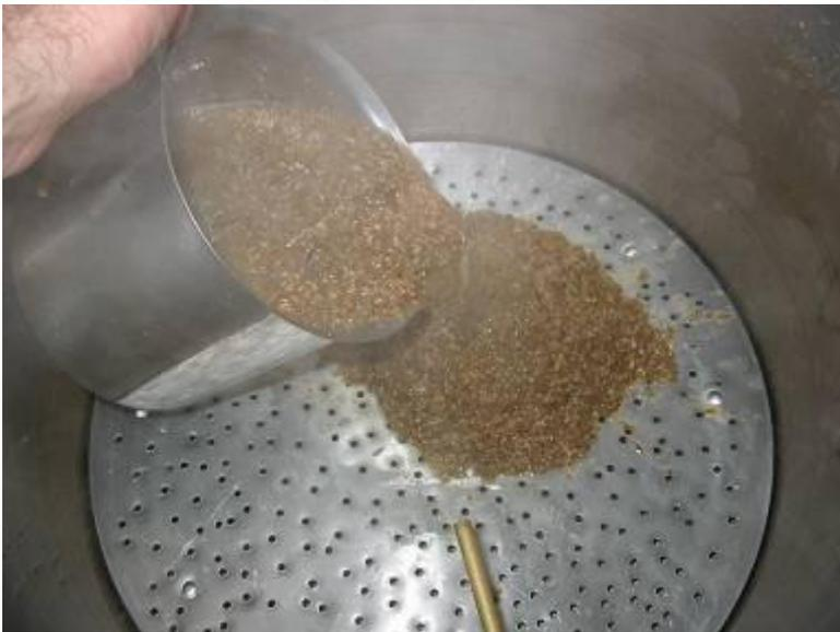
*Fundo falso – após colocar o fundo falso deposite com calma o bagaço*
