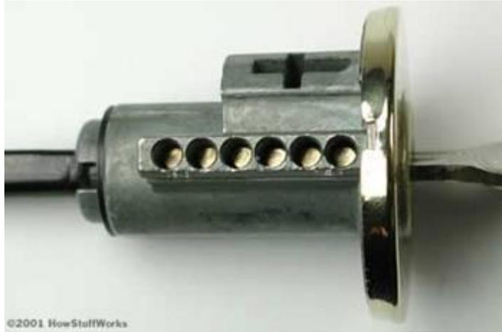
**Uma fechadura cilíndrica de tranqueta e pino**
