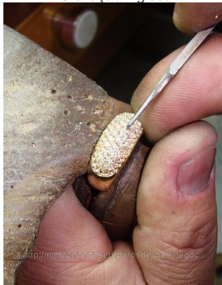
**Cravação com Garras:** neste tipo de cravação, a gema é presa à joia através de garras, e pode ter três, quatro, cinco ou seis garras com acabamento variado.
