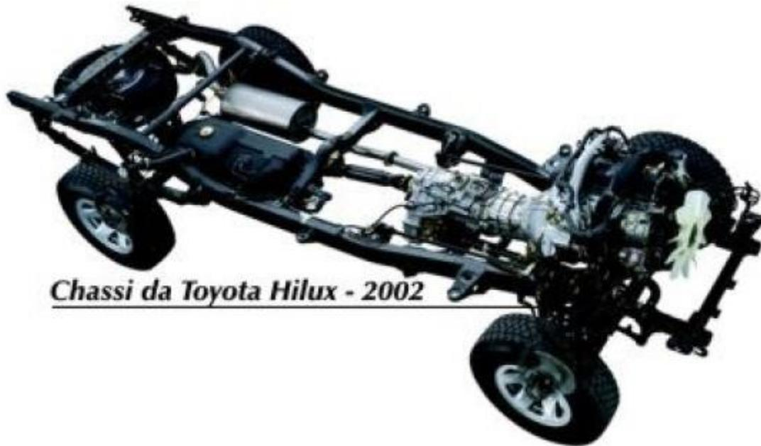
Chassi tem o mesmo significado que suporte, estrutura. Sempre que se monta uma máquina, ou um instrumento, o suporte sobre o qual é montado o conjunto recebe o nome de chassi.
