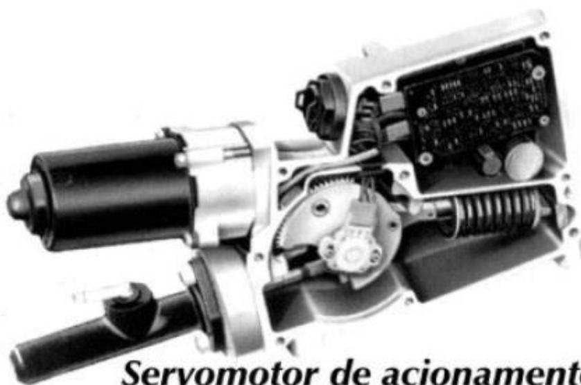
**Servomotor de acionamento do garfo LUK**
