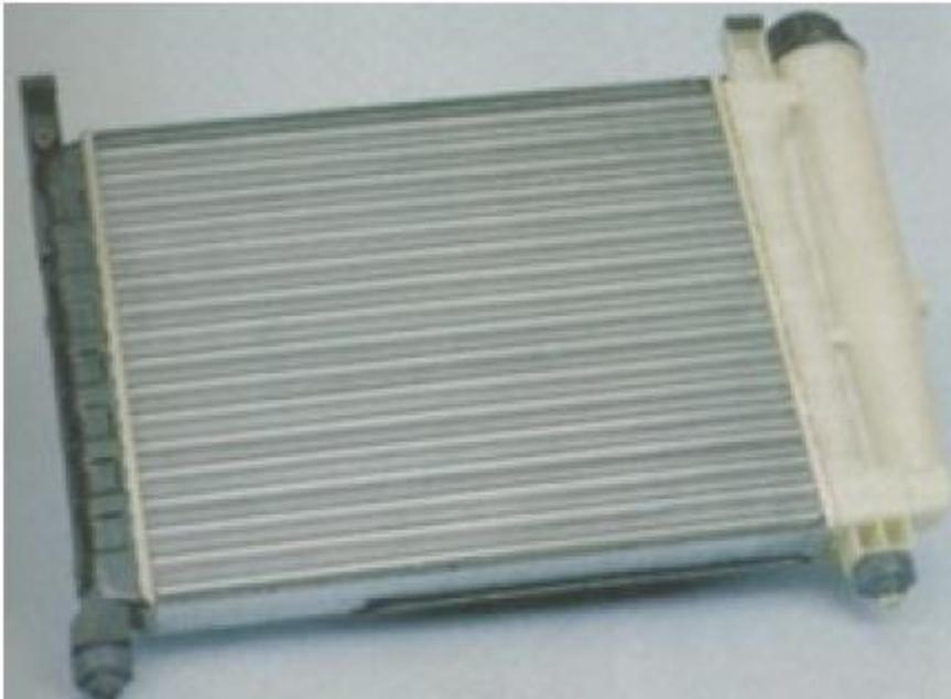
O radiador é um trocador de calor. É constituído por uma porção de cavidades. Por dentro passa a água quente e por fora o ar. O ar está frio e esfria a água. Os radiadores são constituídos em diversos estilos, mas a única diferença que existe mesmo é o tipo de célula de água que se utiliza. Sempre a água passa por um lado da célula e o ar, pelo outro.
