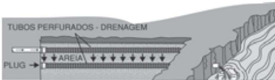
Para a sua construção, podem ser utilizados tubos de PVC rígidos para drenagem, de diâmetro 100 mm, dispostos conforme figura:
