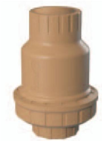
Nas tubulações de alimentação de reservatórios superiores com altura acima de 20 metros, ou em tubulações horizontais que excedam a 200 metros, no caso de recalque horizontal, deve-se utilizar mais de uma válvula. A válvula funciona somente nas instalações com pressão mínima de 0,8 m.c.a. Caso a pressão seja menor que este valor, ela permanecerá fechada.
