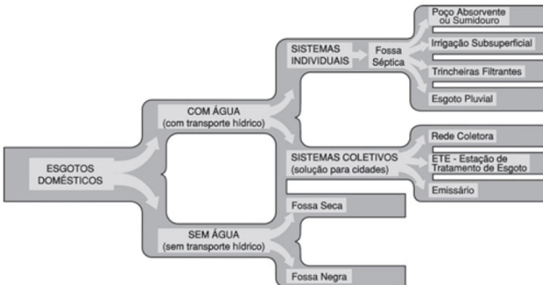
Como podemos ver no esquema anterior, os esgotos podem ser levados ao seu destino final com ou sem “transporte hídrico”, ou seja, utilizando a água para transporte dos dejetos. O transporte hídrico é usado em locais onde há abastecimento de água em
