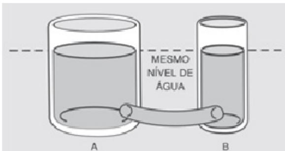
Agora, se adicionarmos água no copo A, inicialmente ocorre um pequeno aumento da altura "h<sub>A</sub>". O nível do copo A, então, vai baixando aos poucos. Com a adição de água, houve um aumento de pressão no fundo do mesmo, a qual tenderá a se igualar com a pressão exercida pela água do copo B.
