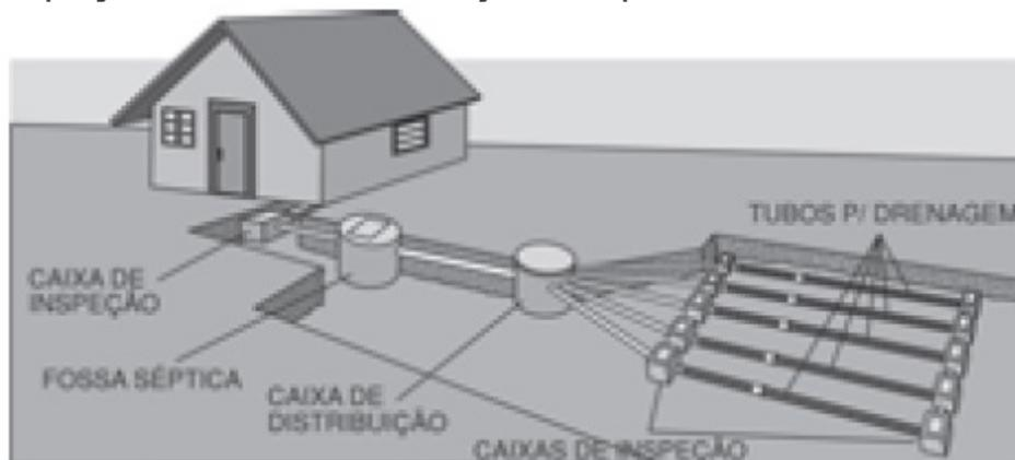
Para a sua construção, podem ser utilizados tubos de PVC rígidos para drenagem, de diâmetro 100 mm, instalados no fundo das valas conforme esquema da figura:
