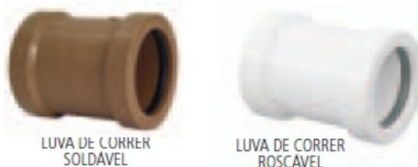
**Conexões LR (Lisa-rosca):** As conexões LR (lisa-rosca), possuem extremidades com rosca e bolsas soldáveis. São utilizadas quando é necessário interligar tubos roscáveis com soldáveis, ou ainda para conectar registros e torneiras não metálicas.
