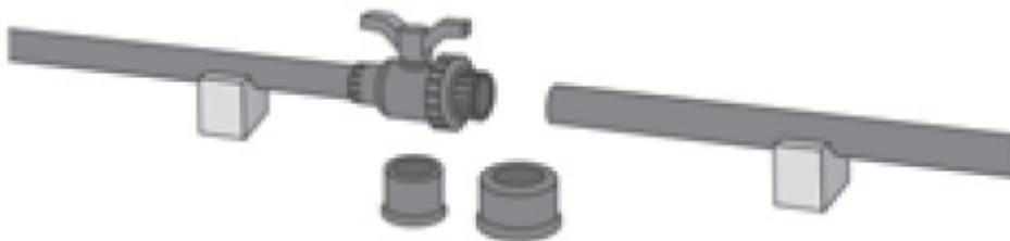
Instale a porca do registro na tubulação e faça a soldagem da extremidade do registro (colarinho).
