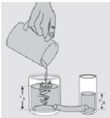
**Conclusão:** A pressão que a água exerce sobre uma superfície qualquer (no nosso caso, o fundo e as paredes dos copos) só depende da altura do nível da água até essa superfície. É o mesmo que dizer: a pressão não depende do volume de água contido em um tubo, e sim da altura. Níveis iguais geram pressões iguais. A pressão não depende da forma no recipiente.
