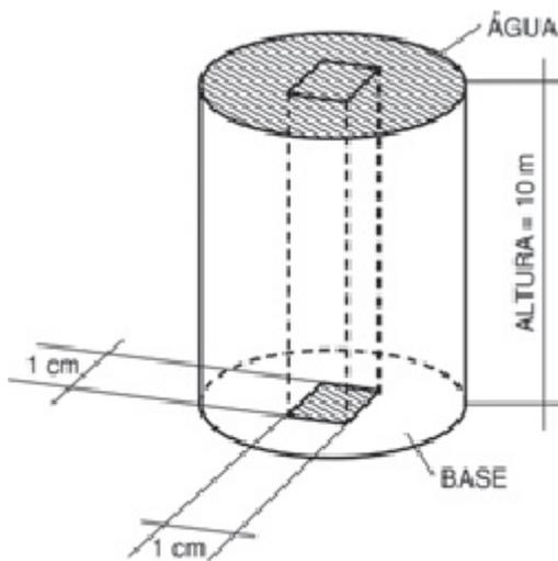
A água contida em um tubo tem um determinado peso, o qual exerce uma determinada pressão nas paredes desse tubo. Qual é essa pressão? Olhando para os dois copos, A e B, em qual dos dois existe maior pressão sobre o fundo? No copo A ou no copo B? A primeira ideia que nos vem à cabeça é de que existe maior pressão no fundo do copo A.
