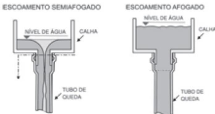
b) Quando existe acúmulo de folhas ou outros materiais na entrada do bocal, que também o afogam e impedem que o ar passe juntamente com a água pela tubulação.
