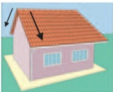
Partes (ou elementos) de um telhado
