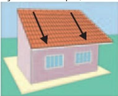
Os telhados são formados por “águas”, que são as áreas planas que conduzem as águas da chuva para uma mesma direção. Os telhados podem ter uma, duas ou mais “águas”. Isso vai depender do formato que o telhado for projetado.
