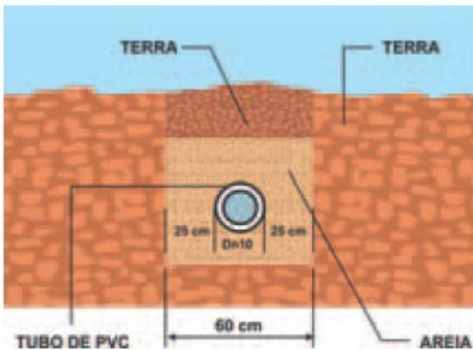
Caso não seja possível executar o recobrimento mínimo, ou se a tubulação estiver sujeita à carga de rodas, fortes compressões ou, ainda, situada sob área edificada, deverá existir uma proteção adequada, com uso de lajes ou canaletas de concreto que impeçam a ação desses esforços sobre a tubulação.
