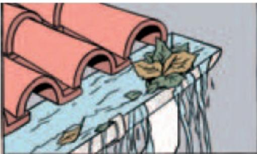
Ao realizar a limpeza, cuidado para não danificar as paredes da calha e suas vedações.
