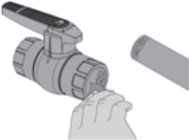
Em seguida limpe as superfícies lixadas eliminando impurezas e gorduras. Aplique uniformemente o Adesivo Plástico com pincel ou o bico da própria bisnaga nas superfícies tratadas (lixadas).
