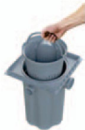
A Caixa de Gordura é fornecida com uma cesta de limpeza, que facilita a retirada da gordura, tornando-a prática e higiênica. Basta para isto retirar a tampa superior.
