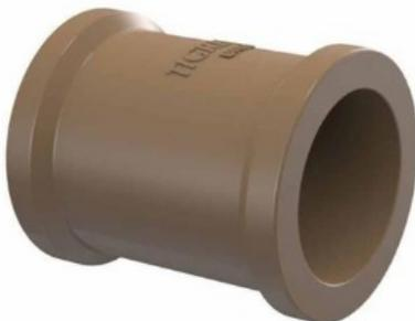
**Luva de Correr:** Para consertar pequenos acidentes que acontecem nas tubulações já instaladas (soldável ou roscável), como furos por pregos ou furadeiras, usa-se a opção da Luva de Correr. Ela facilita em muito a execução de reparos sem a necessidade de equipamentos.
