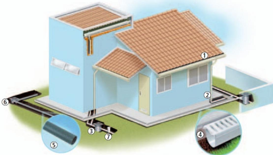
1) **Calhas de beiral:** Tubulação em formato de meia lua ou outro, instalada nos beirais dos telhados, com a finalidade de coletar a água da chuva proveniente dos telhados, encaminhando-a a um condutor vertical.
