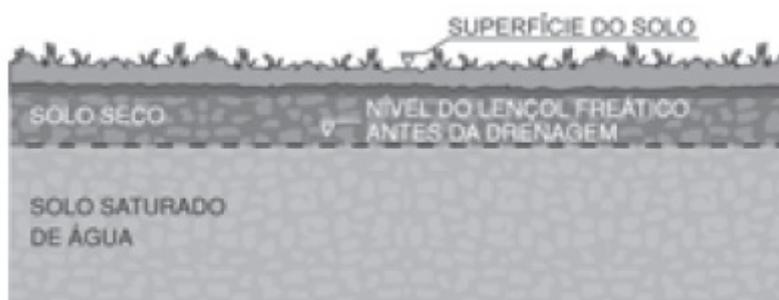
Como a drenagem reduz a umidade do solo, ela acaba rebaixando a altura do lençol freático através da retirada e afastamento do excesso de água subterrânea. Isto oferece maior segurança para as construções, pois entre outros motivos, evita o recalque (afundamento) do terreno.
