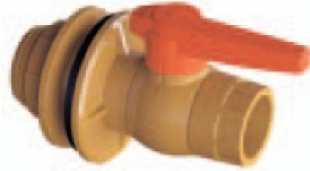
**Registro Borboleta:** Registro de esfera utilizado nas ligações prediais e na tubulação de entrada das Caixas d'Água. Fabricado de PVC nas bitolas de 1/2" e 3/4".
