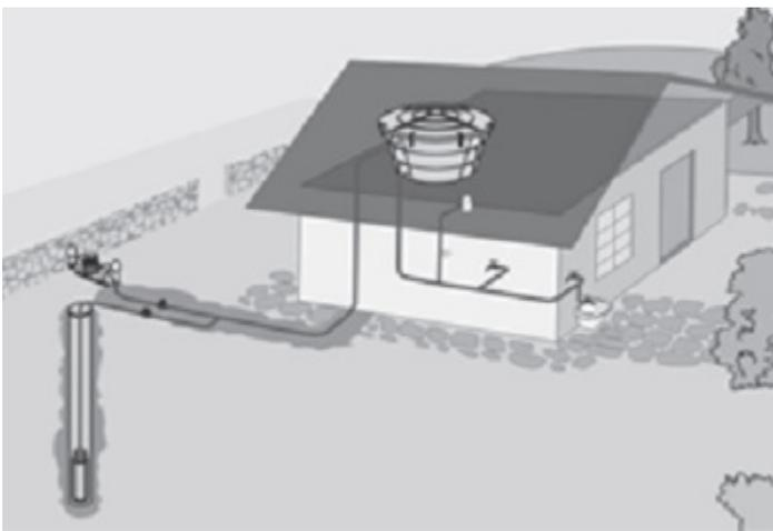
**Distribuição Indireta sem Bombeamento/por Gravidade:** quando utiliza-se reservatório superior para alimentar o sistema predial. Neste caso, a garantia de abastecimento contínuo de água é maior, porém em alguns locais a pressão na rede da concessionária não é suficiente para fazer a água chegar ao reservatório.
