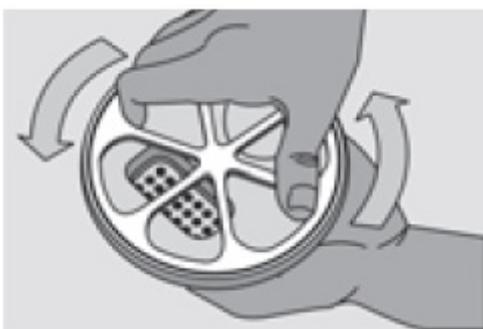
b) Reinstale o Ante espuma na Caixa Sifonada, ajustando-o na caixa através da porca. Em seguida recoloque a grelha.
