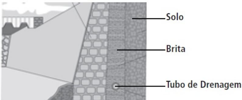
Outra aplicação é no rebaixamento do lençol freático do solo das construções, para protegê-las do recalque do solo (excesso de umidade de possíveis afundamentos do solo pelo peso das construções).
