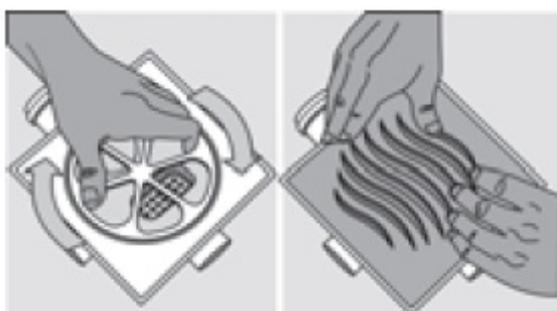
**Manutenção do Ralo:** Alguns modelos de ralo possuem uma cesta de limpeza. Basta retirar a grelha e remover esta cesta através da lingueta, limpando-a com água.
