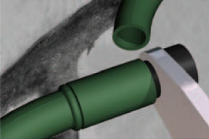
Passo 3: Imediatamente proceda à união, retirando os calços para que a tubulação volte à sua posição normal.
