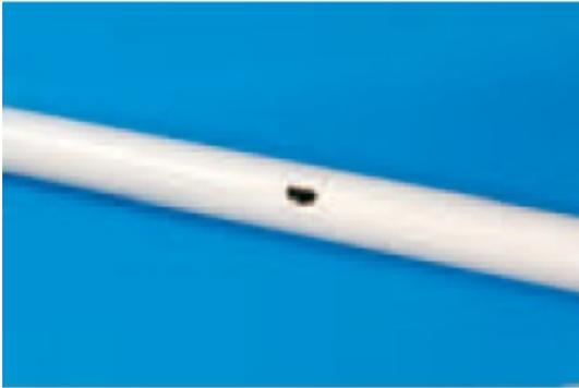
**Passo 2:** Corte o trecho danificado e substitua por outro da mesma tubulação, diâmetro e comprimento. Use duas Luvas de Correr da Linha Esgoto, uma em cada extremidade, aplicando Pasta Lubrificante sobre os anéis.
